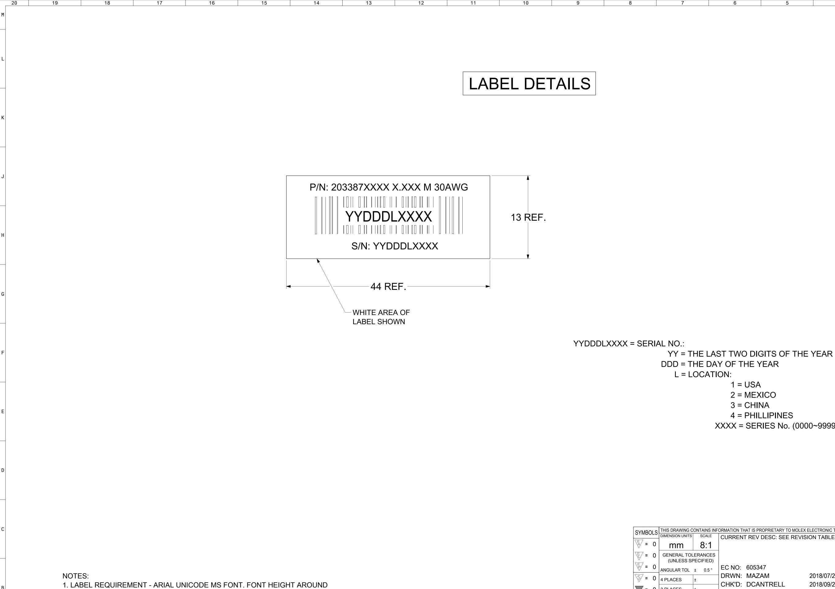
2MM. GAP BETWEEN TEXT AND BARCODE 1.5MM MAX. BARCODE HEIGHT AROUND 6MM. BARCODE 128 B.
