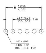
PCB LAYOUT: COMPONENT SIDE RECOMMENDED PCB THICKNESS: 1.57± 0.18 .062± .007
