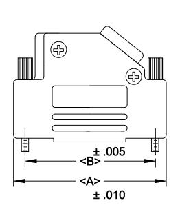
PLASTIC: DIE CAST ZINC ALLOY PLATING: BLACK OVER COPPER JACKSCREWS: STEEL - BLACK HOOD SCREWS: STEEL - BLACK
