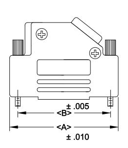
PLASTIC: DIE CAST ZINC ALLOY PLATING: NICKEL OVER COPPER
