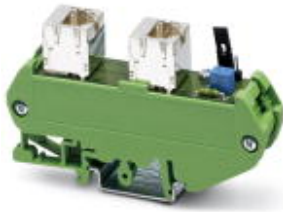
Patchpanel, RJ45, Tragschienenmontage, IP20, 2 Steckplätze, Buchse-Buchse, CAT5e, Schirmung über Jumper wählbar
