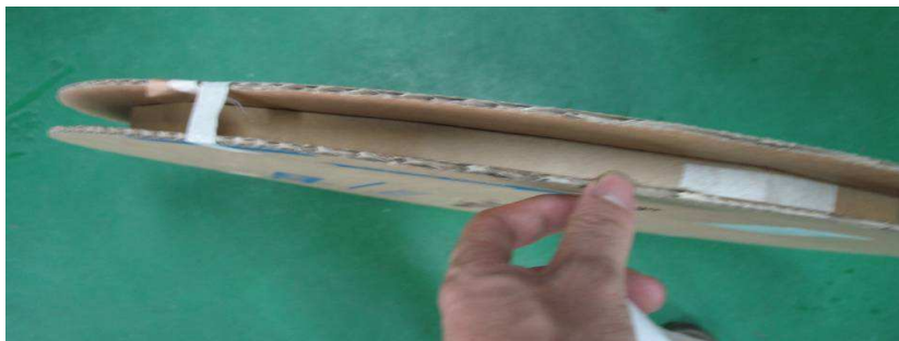
图 3: 纸板带末端用美纹胶带贴紧。
