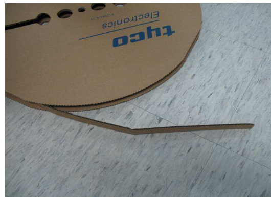
图 2: 在产品reel的外围再缠一圈纸板带
