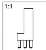
Oberfläche 5-10µm Sn über 2-4µm Cu®
